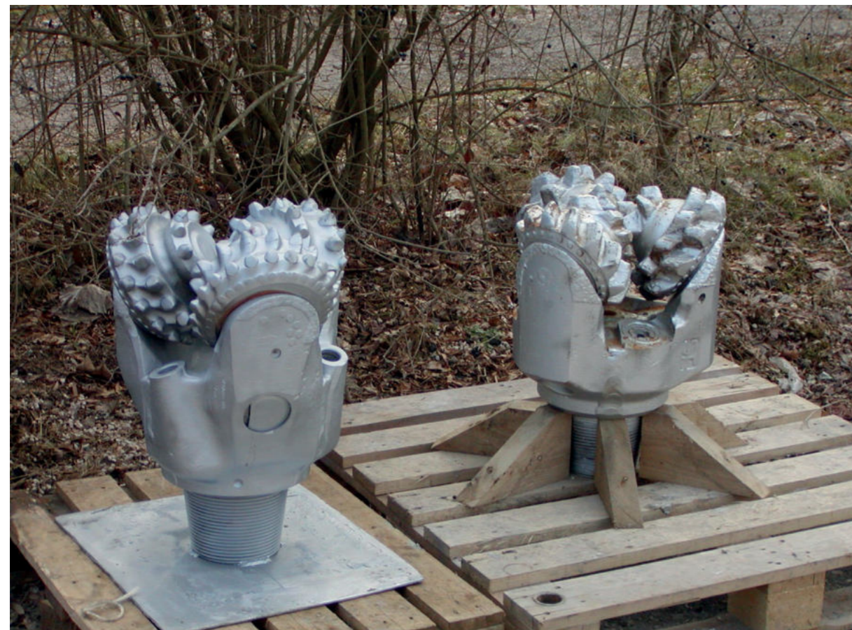
Rollenmeißel für Tiefbohrungen © Stober
