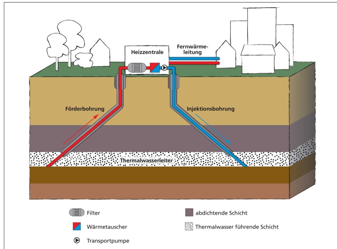
**Abbildung 3.1:** Schematische Darstellung des Thermalwasserkreislaufs einer hydrothermalen Dublette zur Wärmeversorgung. Eine Dublette besteht aus einer Förderbohrung für das heiße Wasser aus dem Untergrund und einer Rückführbohrung (Injektionsbohrung), mit der das abgekühlte Wasser wieder in den Untergrund eingebracht wird.
