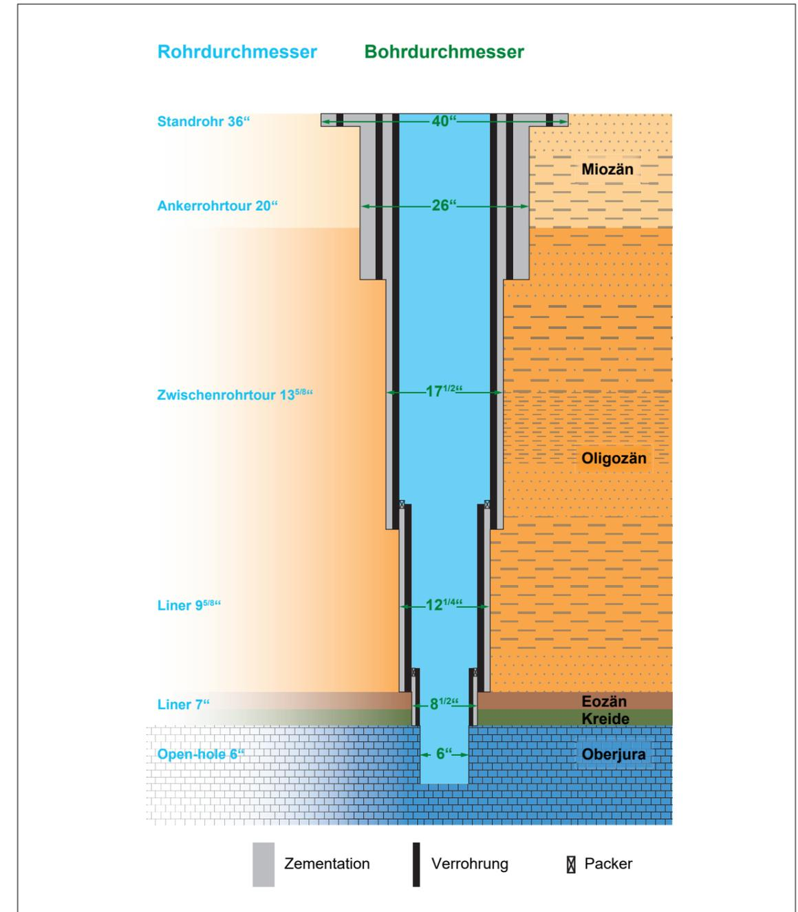
**Abbildung 3.2:** Schematischer Ausbau einer Tiefen Geothermiebohrung. In der Förderbohrung ist im oberen Bereich eine Pumpe installiert (in der Abbildung nicht dargestellt). Die geologische Abfolge ist schematisch eingetragen. Rohr- und Bohrdurchmesser werden in Zoll angegeben (1" = 2,54 cm).
