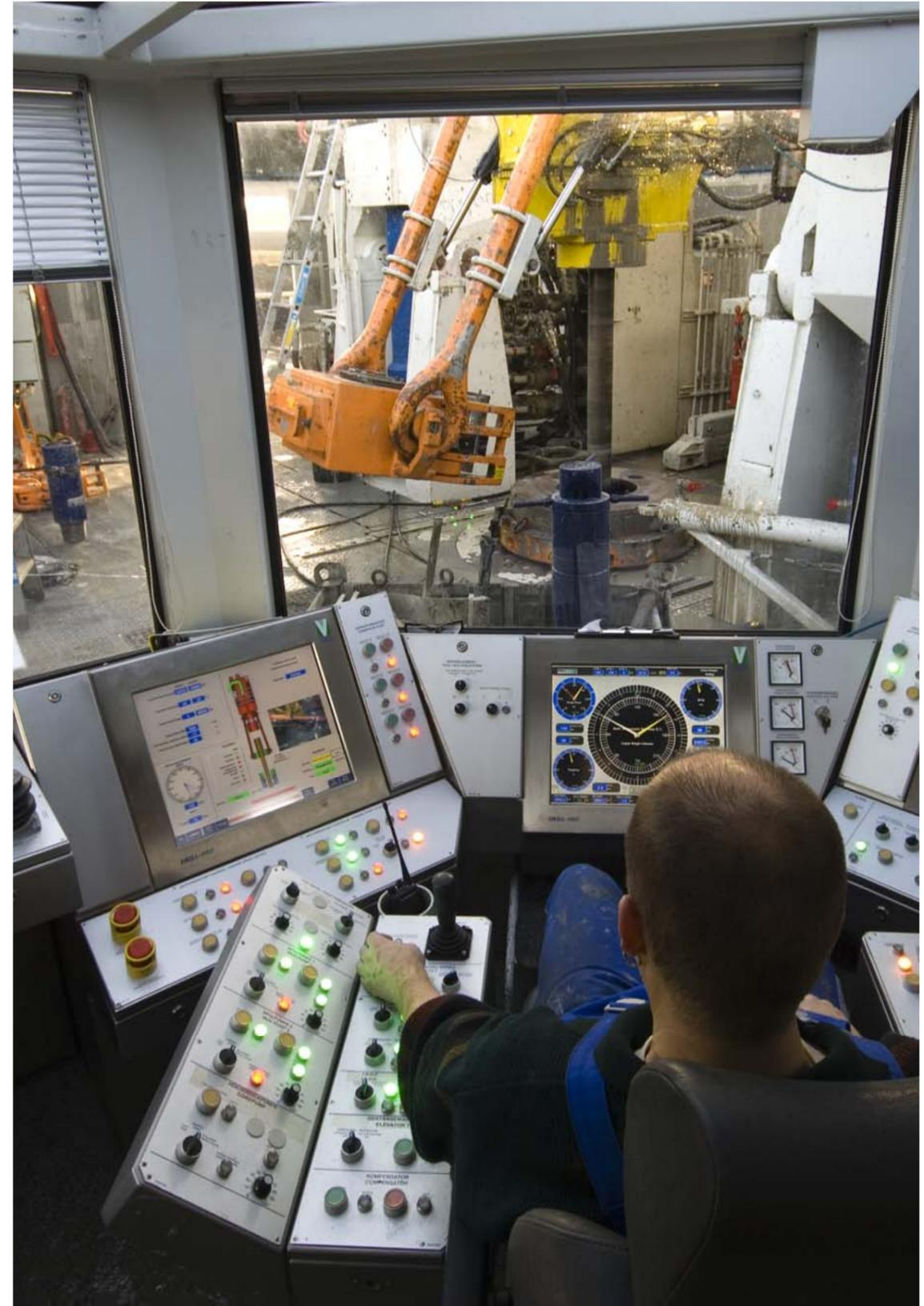
Steuerpult Tiefbohranlage © Herrenknecht AG
