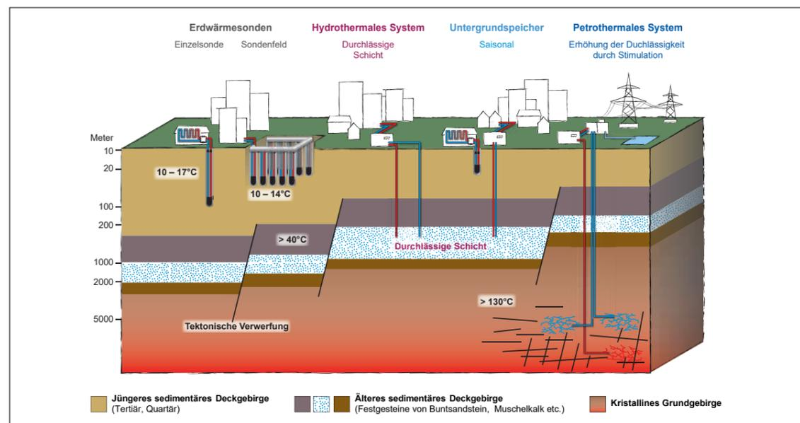
**Abbildung 1.1:** Häufigste Nutzungssysteme der Geothermie: oberflächennahe Geothermie (links), Tiefe hydrothermale Geothermie (Mitte), Tiefe petrothermale Geothermie (rechts). In der Broschüre befassen wir uns mit der hydrothermalen Geothermie, der hydrothermalen Dublette und mit Aquiferspeichern. „Rote“ Bohrungen: Förderung von heißem Wasser, „blaue“ Bohrungen: Rückführung des abgekühlten Wassers.
