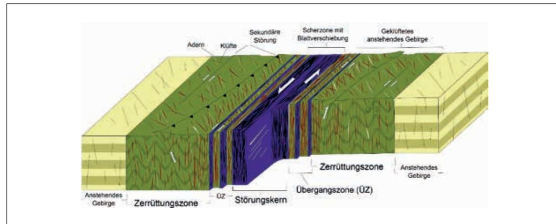
**Abbildung 6.1:** Schematische Darstellung einer Störungszone (angelehnt an Agemar et al. 2017, und Choi et al. 2016). Die Zerrüttungszone weist hier die höchste Durchlässigkeit auf, während der Störungskern hier sehr gering durchlässig ist, geringer als das anstehende Gebirge.
