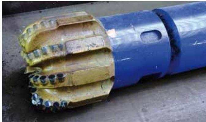
**Abb. 5.7:** Beispiel für ein Bohrwerkzeug für gerichtetes Bohren. Hinter dem Bohrmeißel folgt ein Steuerkopf, mit dem die Richtungskontrolle erfolgt.
