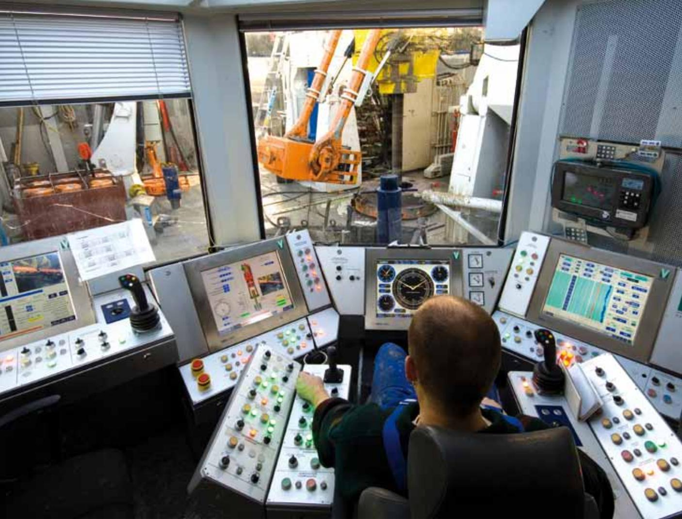
**Abb. 6.2:** Beispiel für einen Steuerpult einer Tiefbohranlage.
