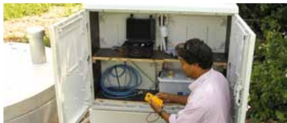
Abb. 4.4: Beispiel für eine seismologische Messstation.
