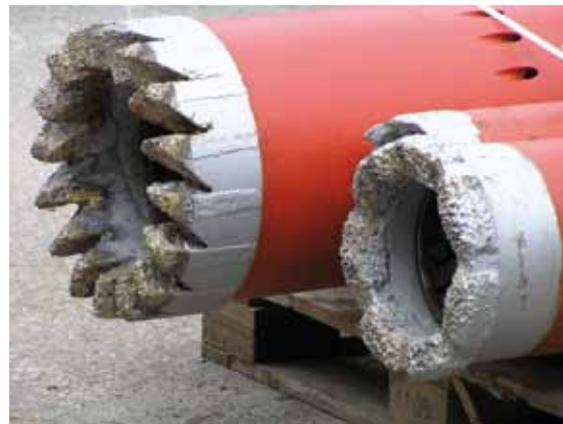
**Abb. 5.1:** Beispiel für großkalibrige Bohrwerkzeuge zum Kern von Gebirgsabschnitten.
