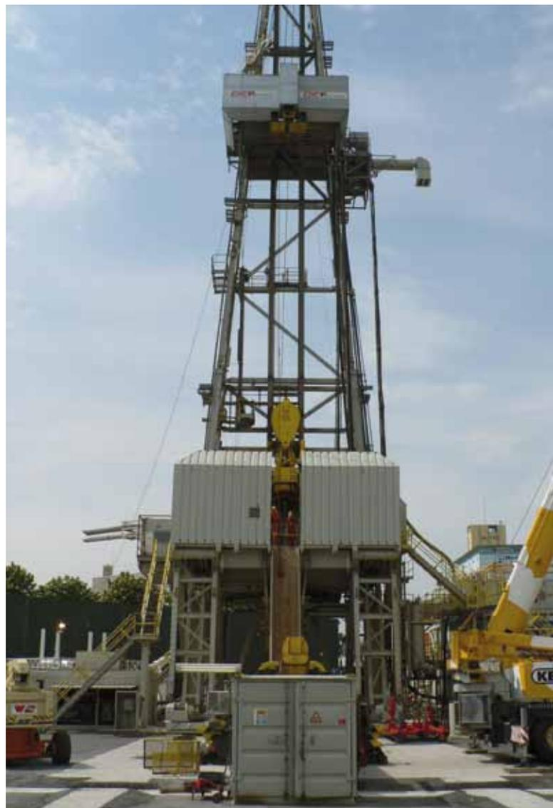
**Abb. 4.7:** Bohrturm zur Erstellung einer Tiefbohrung.
