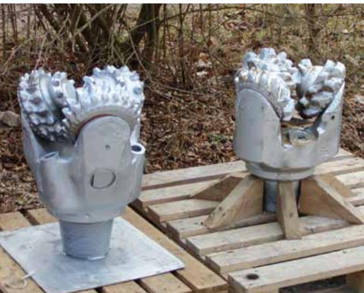
**Abb. 4.8:** Beispiel für Bohrmeißel, die beim Rotary-Bohrverfahren eingesetzt werden.
